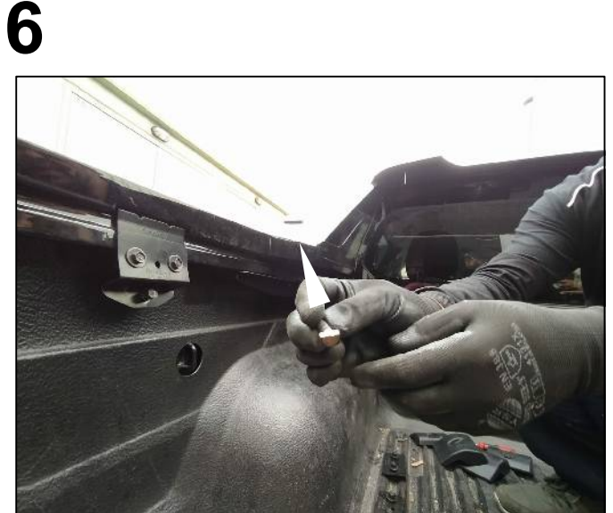
İÇ BAĞLANTI BRAKETİNİ RESİMDEKİ GİBİ CİVATANIN DÜZ KISMI YUKARIYA GELECEK ŞEKİLDE MONTAJLAYINIZ
