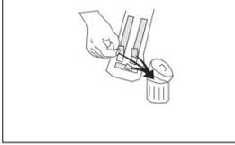
7. Montaj işleminde, yumuşak bez veya parmak uçları ile ürün üzerinden sıvazlayarak oturtunuz. Parça üzerine bir dakika süreli baskı ve yine ortam sıcaklığı 18°C altında ise saç kurutma makinası vb. yardımıyla ısı uygulayınız.
