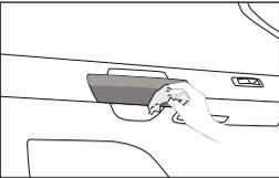
7. Montaj işleminde, yumuşak bez veya parmak uçları ile ürün üzerinden sıvazlayarak oturtunuz. Parça üzerine bir dakika süreli baskı ve yine ortam sıcaklığı 18°C altında ise saç kurutma makinası vb. yardımıyla ısı uygulayınız.
