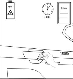
4. Yapıştırılacak yüzeyi pamuklu bez / ispiro / alkol ile titizlikle temizleyiniz. Yapıştırılacak yüzeyi temizledikten sonra tozdan koruyunuz. Yüzeyi su, silikon, benzin, mazot ve kolonya gibi yağlı ve katkılı maddeler ile temizlemek parçanın düşmesine neden olur.
