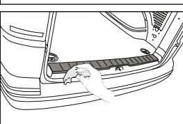
7. Montaj işleminde, yumuşak bez veya parmak uçları ile ürün üzerinden sıvazlayarak oturtunuz. Parça üzerine bir dakika süreli baskın ve yine ortam sıcaklığı 18°C altında ise saç kurutma makinası vb. yardımıyla ısı uygulayıniz.
